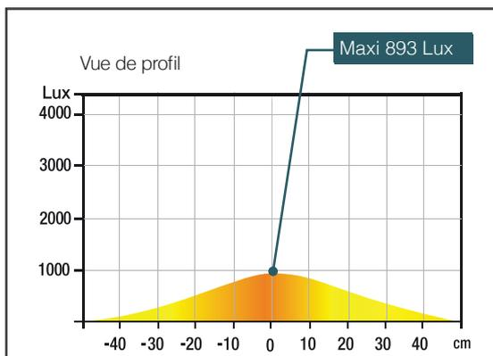
Mesure des Lux vers le haut à 55 cm de la source lumineuse:
