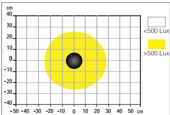
Mesure des Lux sur le plan de travail en vue de profil à 27 cm:
