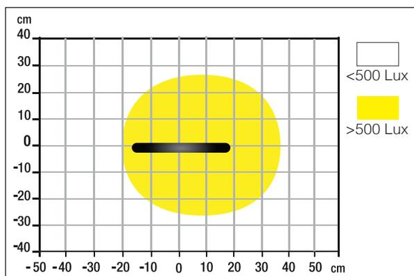
Mesure des Lux sur le plan de travail en vue de profil à 40 cm:
