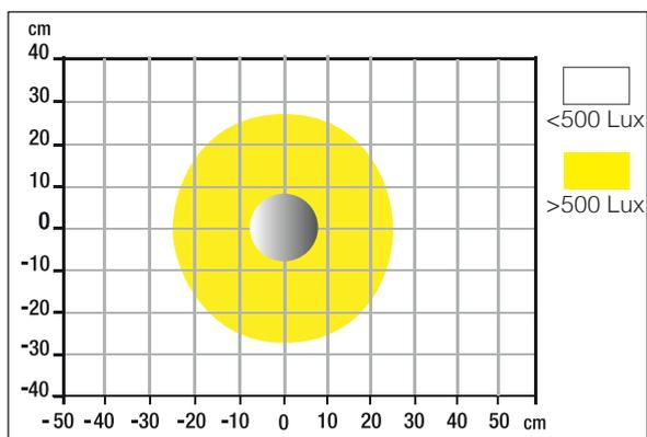
Mesure des Lux sur le plan de travail en vue de profil à 35 cm:
