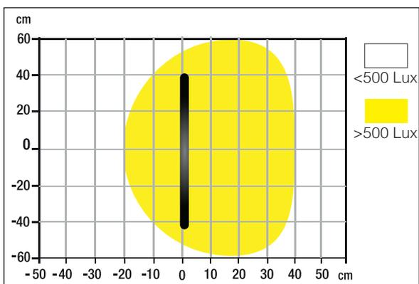
Mesure des Lux sur le plan de travail en vue de profil à 50 cm:
